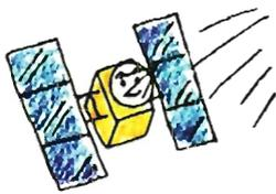
僕は太陽電池パネルを広げ、太陽の光を電気に変えた。この電気でイオンエンジンを動かす。このエンジンを本格的に使うのは僕が初めてなのだ。力は弱いけど、長い時間をかけて少しずつ小惑星に向かって加速してゆく、僕の旅にぴったりのエンジンだ。
