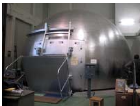
< 磁気シールドルーム外観 >
