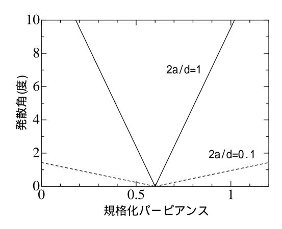
アスペクト比が 0.1 のとき発散角は約 1 度であるが、イオン電流は 1/100 となる。 このとき、1km 先のイオンビームの照射範囲は以下となる。
